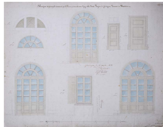
Fig. 16 Luigi Fontana, Delineazione dei principali serramenti pel Pian Terreno del nuovo Ospizio della Beata Vergine di Fondazione Turconi in Mendrisio , marzo 1856. Fondo OBV, Archivio Storico Comunale, Mendrisio.
